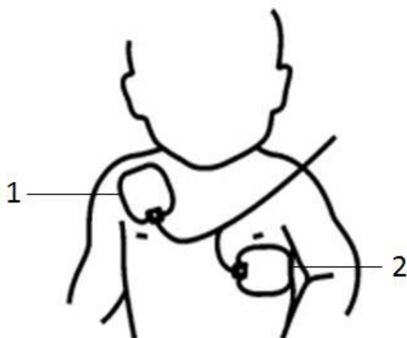
Fig. 14: Posizioni degli elettrodi per uso pediatrico
